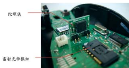
圖 6 空中運動感測器微機電陀螺儀和桌面運動感測器雷射光學模組
